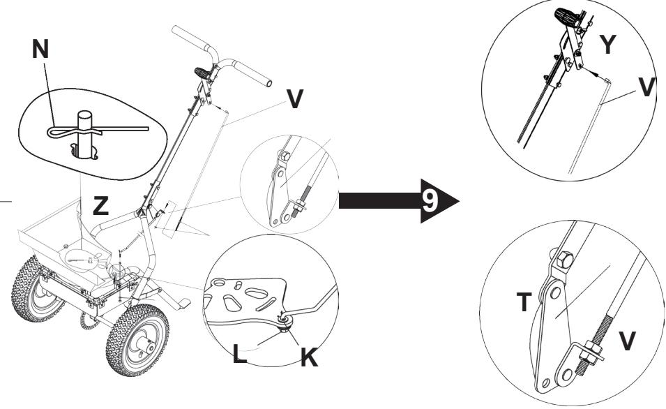
Die Verbindungsachse (T) Stange an die klappe unter dem Behälter(Z) befestigen
