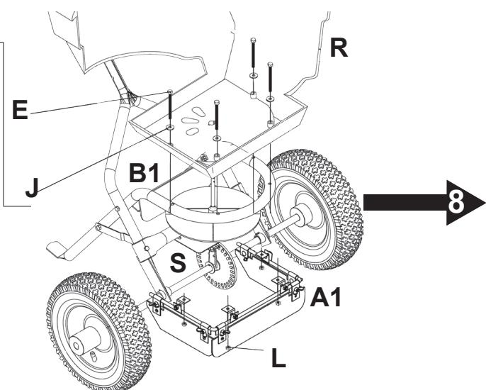
**Wichtig:** Sichern Sie sich dass die Deflektoren (A1) gesenkt sind und dass das Beschlag, auf dem Getriebe, in einer Linie ist.
