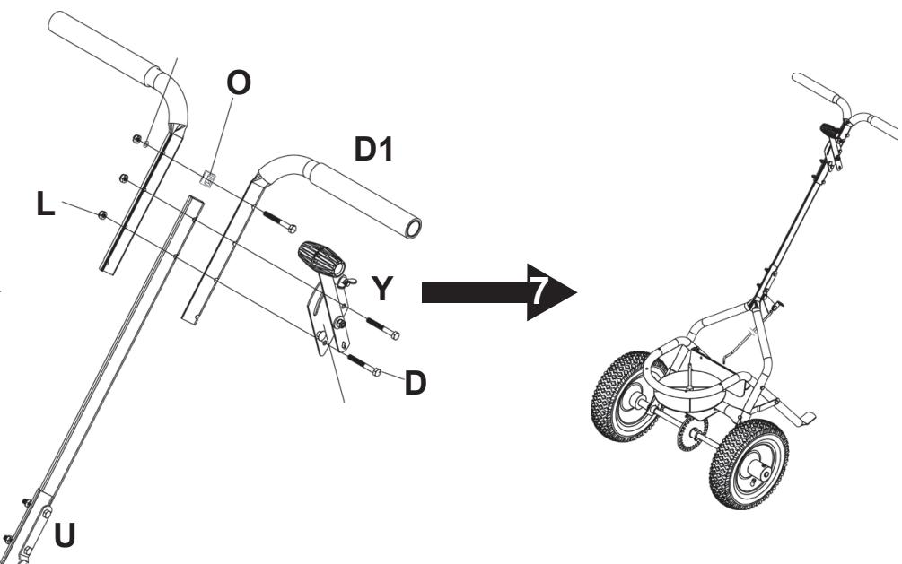
Die Distanzhülse (O) in das Loch des Verbindungsstange (U) befestigen. Den Bolzen (D) im Griff (D1) einführen und mit Schraubenmutter (L) befestigen. Die anderen Bolzen Nachspannen.
